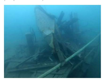
Bei Bauarbeiten an der Uferlinie kam es diese Woche durch ein Ankermanöver der Baufirma zu einem Vorfall, die das Führerhaus so massiv beschädigte, dass dieses praktisch vom Oberdeck verschwunden ist.
