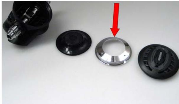
In der Regel reicht eine kurze visuelle Prüfung von außen, sicherheitshalber sollte aber der Frontdeckel kurz aufgeschraubt werden um sicher zu stellen, dass die Abdeckung vorhanden ist.
